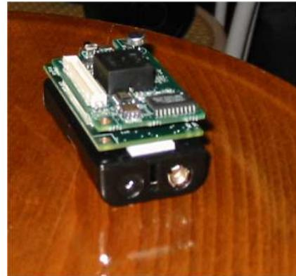
Σχήμα 8.17: Ένα MICa mote με το MTS310 sensor board
