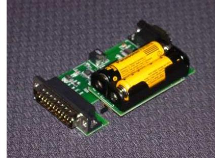
Σχήμα 8.15: Ένα MICA mote προσαρτημένο στο programming board
