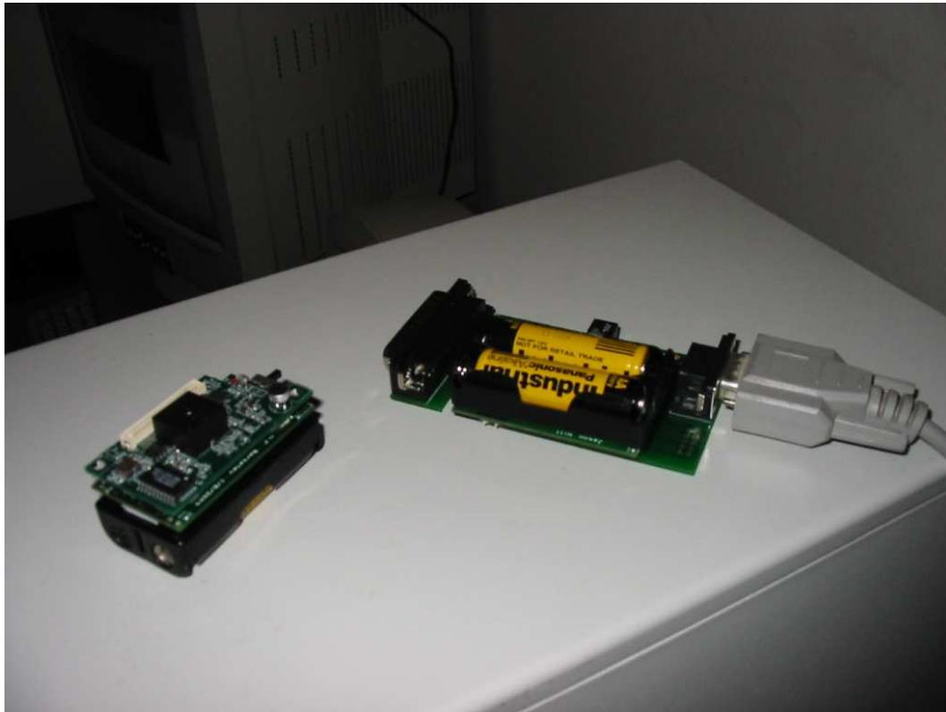
Σχήμα 10.1: Το mote με το OscilloscopeRF και το εικονικό κέντρο ελέγχου (mote πάνω στο programming board)
