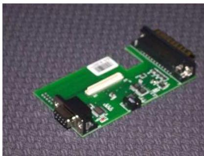
Σχήμα 8.14: Programming board
