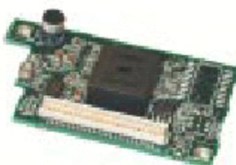
Σχήμα 8.16: Το MTS310 sensor board
