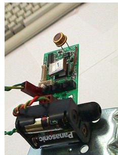
Σχήμα 8.7: Laser mote
