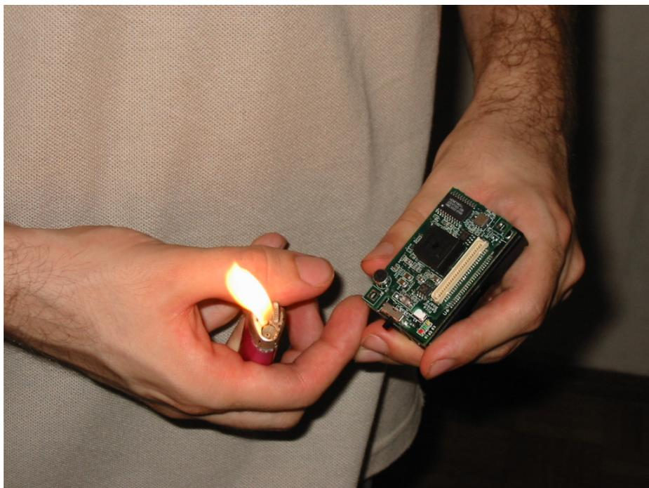
Σχήμα 7.3: Προκαλούμε απότομη άνοδο της θερμοκρασίας με ένα αναπτήρα
