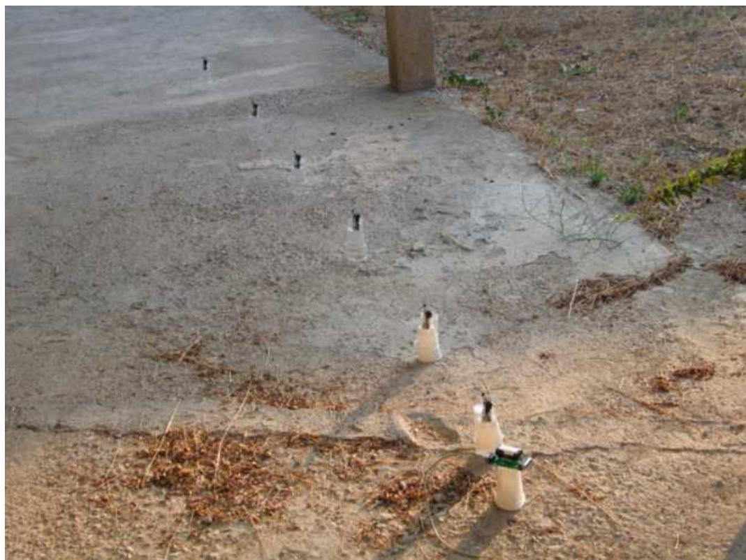
Σχήμα 5.1: Παράταξη των κόμβων του μικρού ασύρματου δικτύου μαζ (6 hops-7 κόμβοι).
