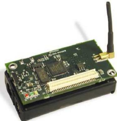
Σχήμα 2.5: Φωτογραφία ενός Micaz με κεραία. ( Πηγή Εικόνας: [www.crossbow.com](http://www.crossbow.com) )
