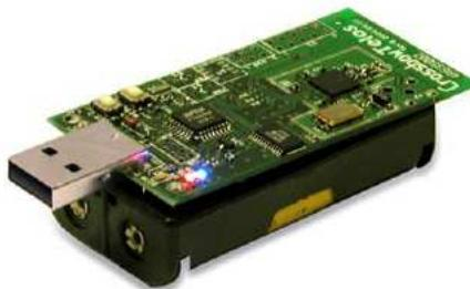
Σχήμα 2.7: Φωτογραφία ενός Telos-B με κεραία. ( Πηγή Εικόνας: [www.crossbow.com](http://www.crossbow.com) )
