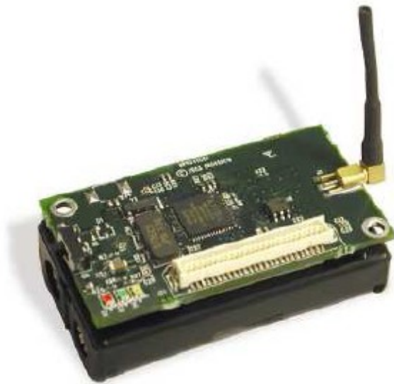
Φωτογραφία ενός Mica2 με κεραία.
