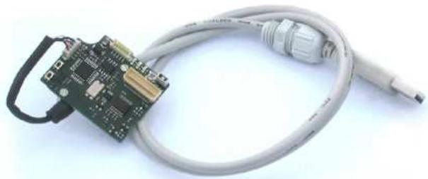
Σχήμα 5.6: iSense Gateway Module με USB καλώδιο.
