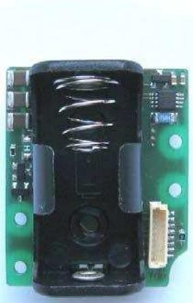
Σχήμα 5.4: Το power module 1/2AA Battery της πλατφόρμας iSense.
