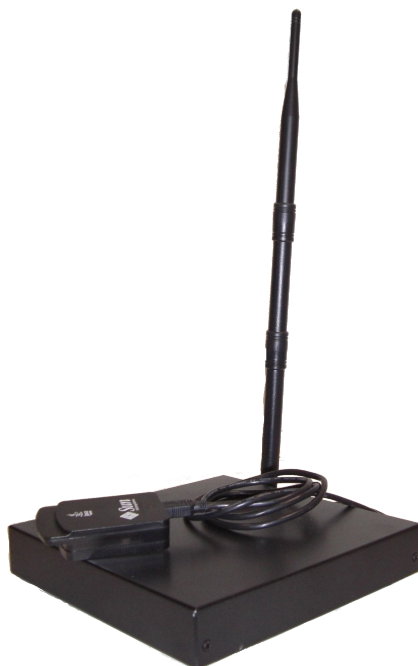
Σχήμα 3.10: Μια τυπική εγκατάσταση ενός Σταθμού αποτελούμενη από ένα Alix board με δυνατότητα σύνδεσης σε WiFi και ένα 802.15.4 gateway.
