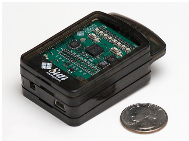
Σχήμα 3.1: Ένας αισθητήρας Sun SPOT: μια μικρή, ασύρματη πειραματική πλατφόρμα.
