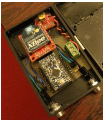
Εικόνα 2.3 Πλακέτα ελέγχου HVAC
