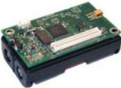
Σχήμα 3.2: To MicaZ mote.
