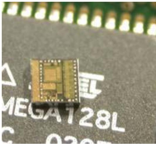
Σχήμα 3.4: Το SPEC mote επάνω στην επιφάνεια ενός επεξεργαστή AVR που χοησμοποιείται στα Mica mote.
