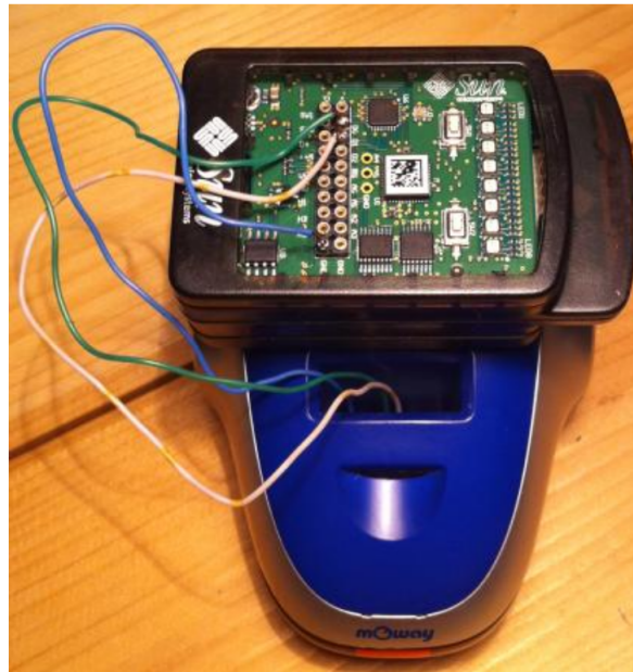
Σχήμα 3.3: Διασύνδεση SunSPOT με Moway Robot
