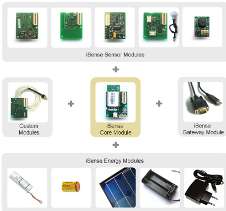
Σχήμα 5.2: Τα Στοιχεία Υλικού της Πλατφόρμας iSense.
