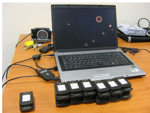
Σχήμα 6.7: Συσκευές SUN SPOT
