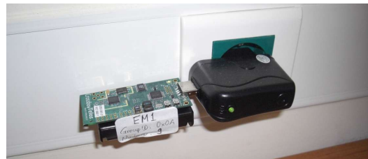
Σχήμα 6.3: Συσκευή TelosB με μόνιμη τροφοδοσία
